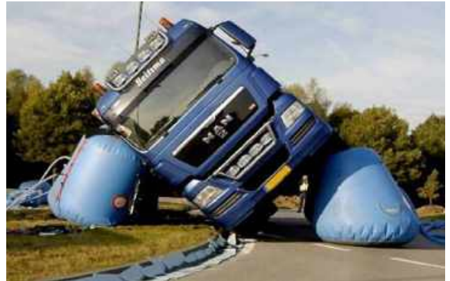
Hebekissen zur Bergung von Lastkraftwagen
