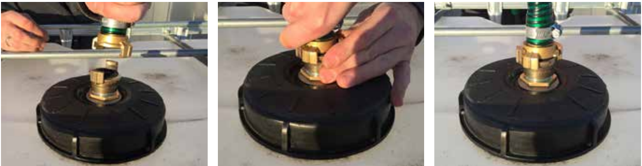
Wasserschlauch über Schnellkupplung an den IBC-Container angeschlossen
