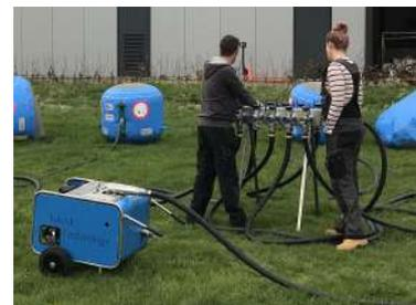
Les tuyaux d'air fournis avec sont de très haute qualité, résistants aux UV et aux intempéries et aussi antistatiques, il est donc possible et sécurisé de travailler avec des substances inflammables, par exemple, à proximité des camions-citernes.
