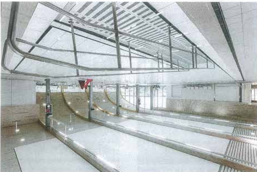
De doeken van de Franse fabrikant Serge Ferrari zijn chloorbestendig en hebben goede akoestische eigenschappen.
