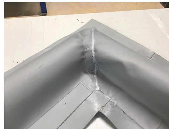
Ingelaste hoek: hier de lasnaad en de overgang naar de basisstrook extra afkitten
