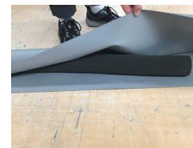
Schuimkern op de basisstrook met doorgestikt keerrubber
